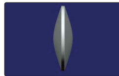
非球面轻质凸透镜, 中心和边缘的曲率不同, 从而减少边缘的成像变形
